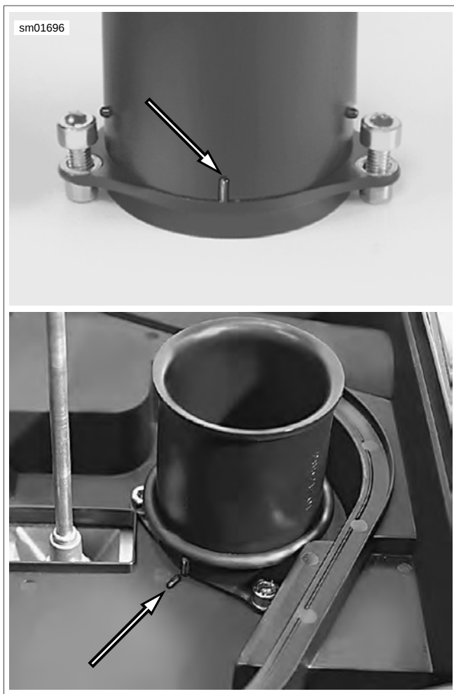
Figure 1-14. Repères d'alignement de colonnes d'admission
